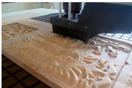
výroba znaku ČR na CNC stroji - truhlárna
